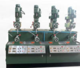
QTMJ-80型 四头球体研磨机 Four-headed Ball Grinding Machine of Model QTMJ-80
