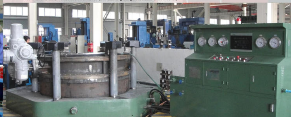
使用单位: 科福龙阀门集团有限公司 User: Koflow Valve Group Co., Ltd. 设备型号名称: YFS-DL3000型 液压蝶阀试验台 (用于试压大口径蝶阀) Machine Model & Description: Hydraulic Butterfly Valve Test Bench of Model YFS-DL3000 (for Testing Large Size Butterfly Valves)
