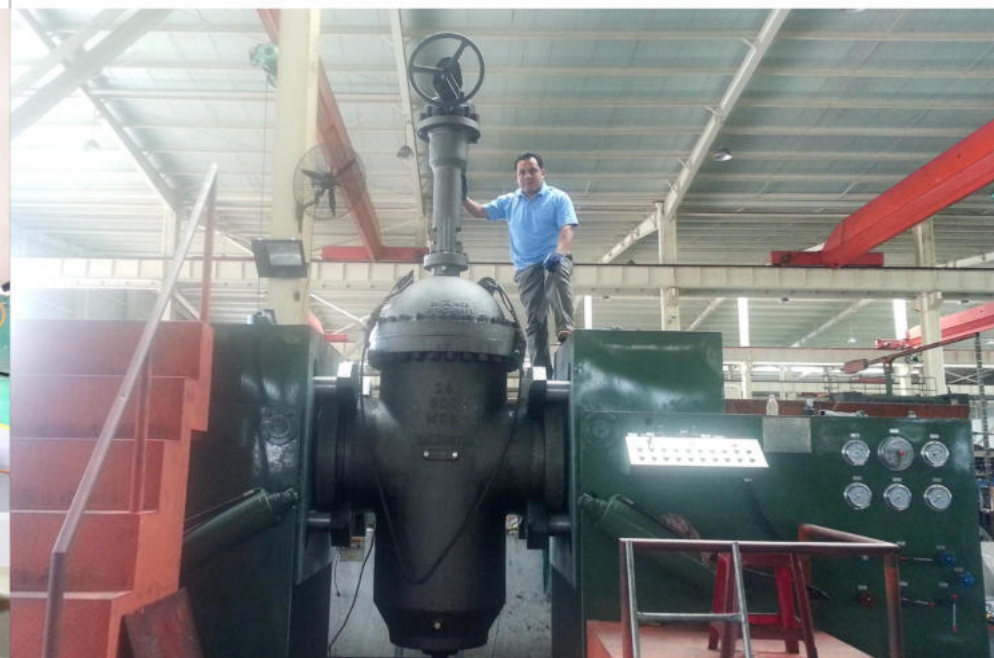
使用单位: 科福龙阀门集团有限公司 User: Koflow Valve Group Co., Ltd. 设备型号: 设备名称型号名称: YFS-Z800型 液压阀门试验台 (用于试压大口径平板阀) Machine Model & Description: Hydraulic Valve Test Bench of Model YFS-Z800 (for Testing Large Size Flat Gate Valves)
